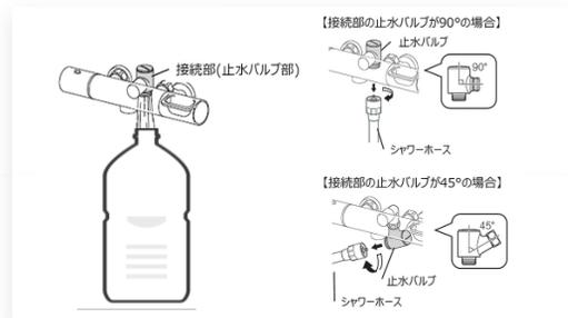
シャワーホースをシャワーヘッド根本から取り外して、接続部(止水バルブ)から吐水して流量を計測してください。
