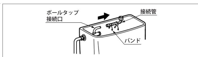
④新しい接続管の細い端部をボールタップ接続口にしっかりと差し込み、バンドでボールタップ接続口にしっかりと接続します。
