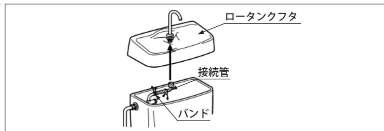
③ボールタップ接続口側のバンドを同様に接続管側にずらしゴム管を外します。
