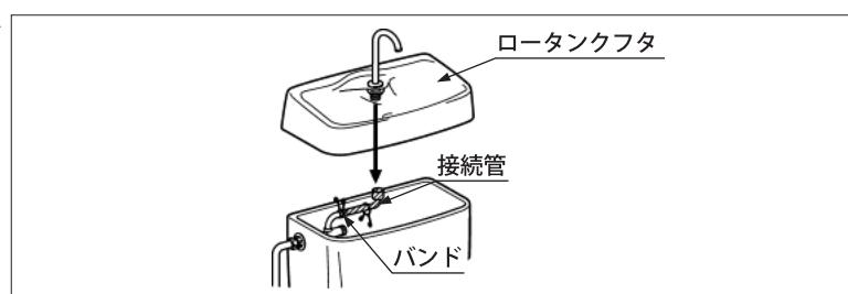
⑥止水栓を元の位置まで開け、ボールタップからの給水停止後にロータンク内水位がほぼWLラインであることを確認してから、洗浄ハンドルを操作し、便器洗浄が正常に行われ漏れなどの不具合がないことを確認します。
