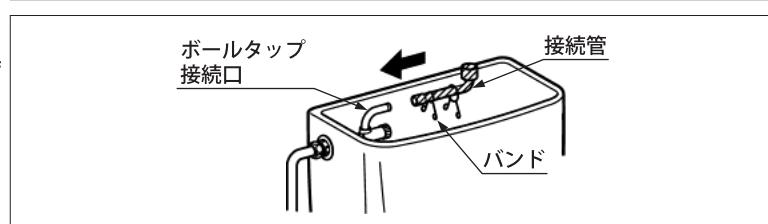
⑤手洗吐水口ネジ部に接続管の太い端部をしっかりと差し込み、バンドで手洗吐水口ネジ部にしっかりと接続してからフタをのせます。
