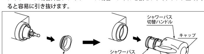
④新しいシャワーバス切替弁部をセットし、モンキーレンチで固定ナットを締め付け、シャワーバス切替ハンドルを仮セットします。
