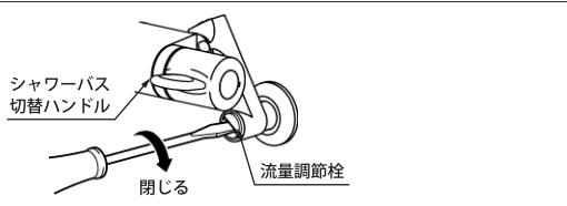
②精密ドライバー(マイナス)をシャワーバス切替ハンドルのキャップ溝に差込み、キャップを外します(抜きます)。手でシャワーバス切替ハンドルを抜き取ります。
