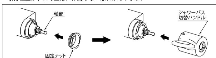
⑤流量調節栓を元の位置まで開け、シャワーバス切替ハンドルを操作し、動きがスムーズか、切替方向通りに湯水が出ているか、漏水などの不具合がないかなどを確認します。
