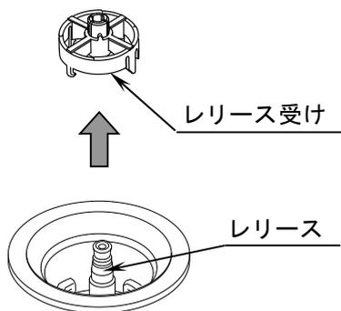
⑤押ボタンにガムテープ等を張って、1度押し込んでから引き上げて押ボタンを取り外し、リリースを引き抜きます。
