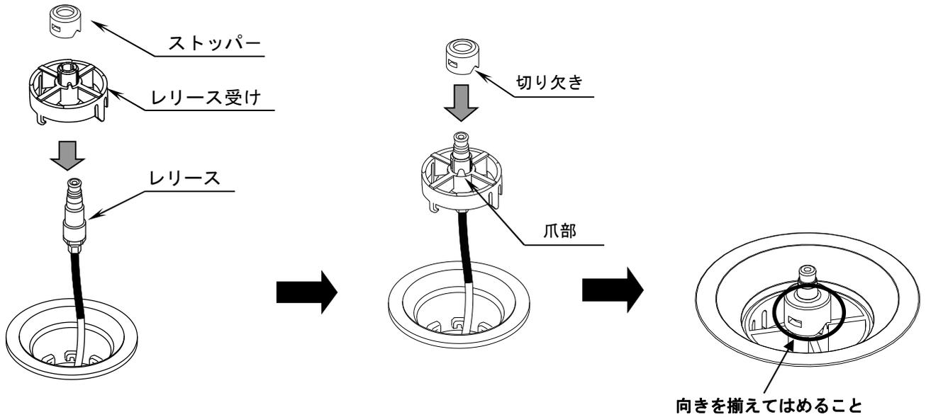
注) ストッパーの切り欠きを、リリース受けの爪にパチンと確実にはめてください(4カ所)。
