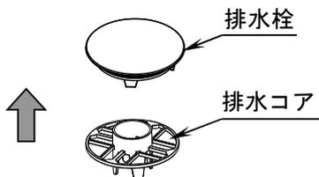
③リリース受けがバス排水口に固定された状態でストッパーを取り外し、リリース先端を押ししてリリース受けの嵌合部分から外します。
