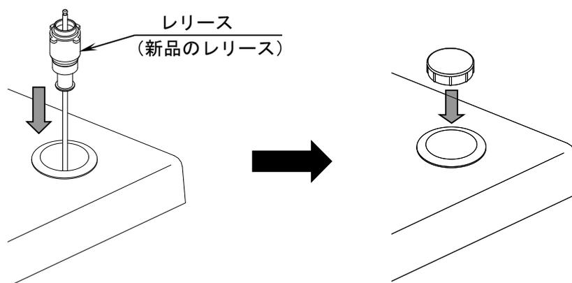
⑦リリースの先端を排水口締付ナットに挿入します。
