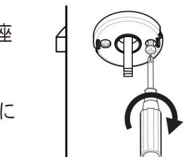
⑨ 再度レバーハンドルを差込み、両側のレバーハンドルを押付けながらハンドル取付けネジで固定する。
