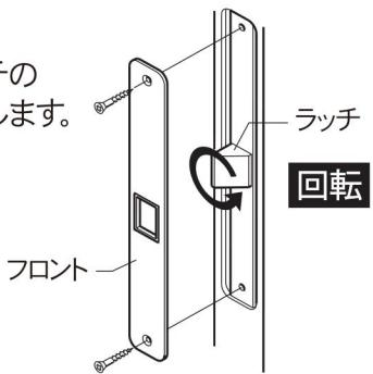
箱錠のラッチは右吊元の向きになっています。左吊元として使用する場合はフロントを外し、ラッチを180°回転させてください。
