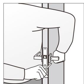
必ずハンドル軸部を手と腰で押しながら、止めネジで固定してください。押付けないとハンドルの前後のガタツキの原因となります。
