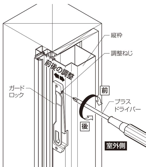
※ガードロック側面のねじを回すことで、アームを前後に移動させることができます。
