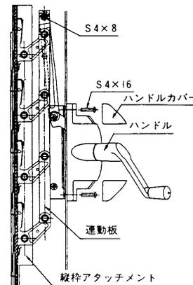
● ハンドルのアームを縦枠の角穴に入れ、ハンドルアームと連動板をS4×8トラスビスで固定して下さい。次にハンドル本体をS4×16トラスビスで縦枠に固定して下さい。
