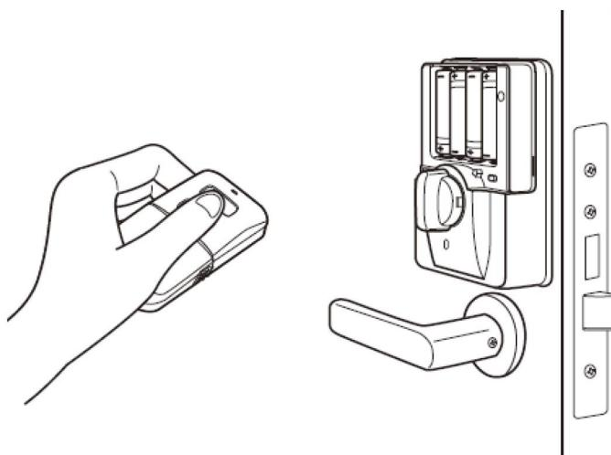
③ すべてのリモコンの登録操作が完了したら、ディップスイッチの5番を「OFF」に戻し、電池カバーを取り付ける
