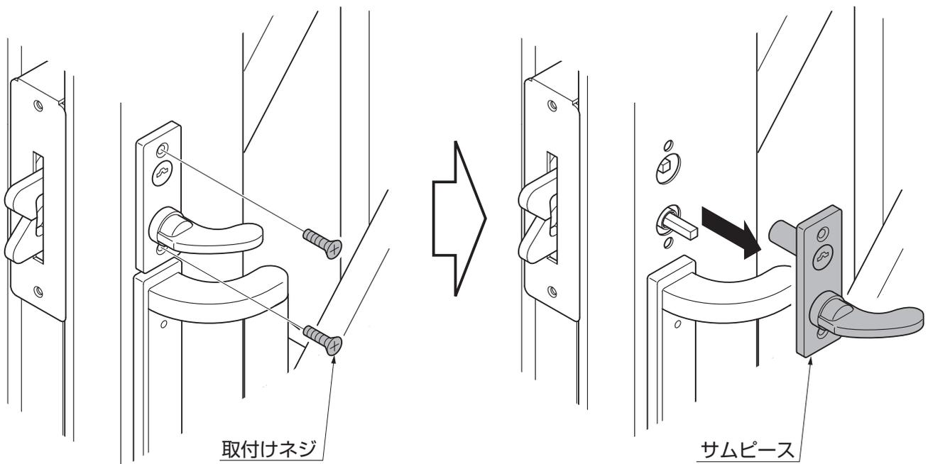
①取付けネジを外し、サムピースを取外してください。
