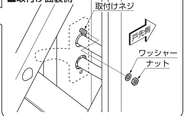
③固定穴に取付けネジを挿入し裏側にナットとワッシャーをはめ、サムピースを仮固定してください。
