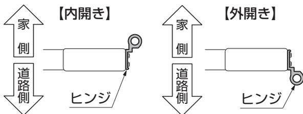
図1-2 ヒンジ取付け方向
