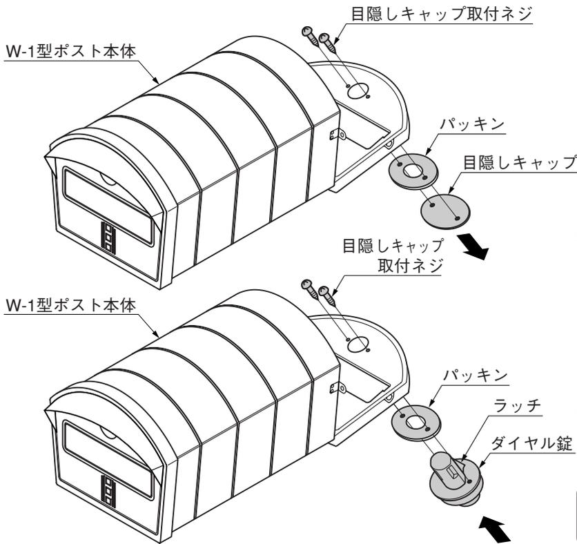
① 目隠しキャップ取付ネジを外して、目隠しキャップとパッキンを外してください。
