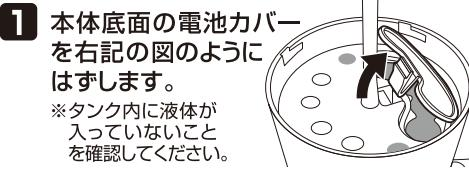
1 本体底面の電池カバーを右記の図のようにはずします。
