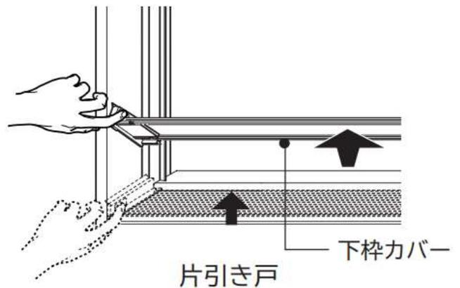
② 下枠カバー端部ピースを外します。
