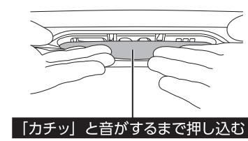
△注意 | •「ノズルシャッター」に強い力をかけない（破損の恐れ）
