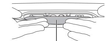
注意 | •「ノズルシャッター」に強い力をかけない（破損の恐れ）
