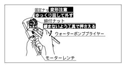
③水栓本体からヘッドパーツを引き 抜いて外します。
