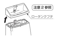
(3) タンクから接続管を外し、中 フタツメ3カ所(図中矢印) の勘合を外します。
