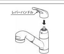
⑨ドライバー（プラス）で固定ネジを右に回して締め込み、レバーハンドルをヘッドパーツに固定してからキャップをはめます。
